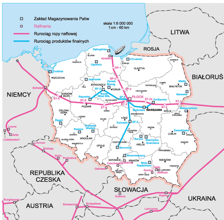
Rys. 11.3. Krajowa sieć rurociągów ropy naftowej oraz produktów finalnych.
